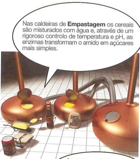
Nas caldeiras de **Empastagem** os cereais são misturados com água e, através de um rigoroso controlo de temperatura e pH, as enzimas transformam o amido em açúcares mais simples.
